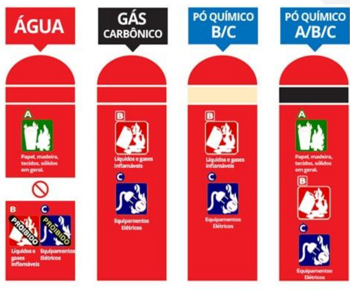
Imagem 09 – Tipos de extintores
